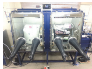
図2 Arガス循環精製機構付大型グローブボックス
