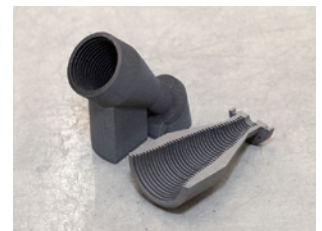
アルマ望遠鏡に搭載された超高感度超伝導受信機 右は3Dプリンターで作られたそのパーツ
