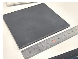
図2 活性炭をSPSにより固化した例
